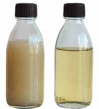
Prozessöl bei einem deutschen Hersteller von Common-Rail-Einspritzsystemen vor und nach dem Recycling
