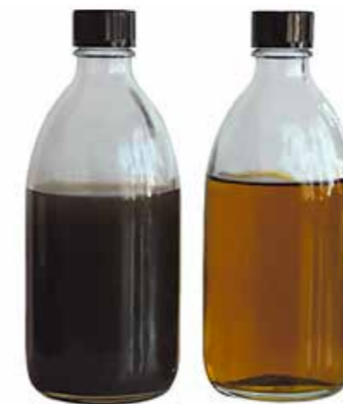
Prozessöl bei einem deutschen Premium-Automobilhersteller vor und nach dem Recycling
